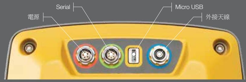
電源 | Serial | Micro USB | 外接天線
